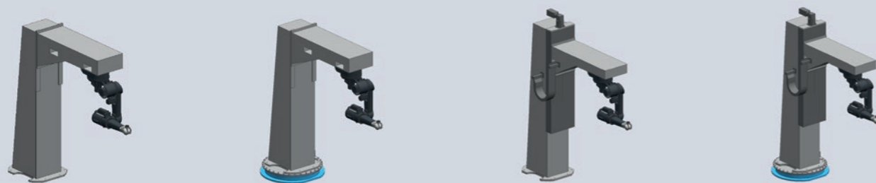
C-Ständer mit/ohne Zusatzachsen zur Vergrößerung des Roboterarbeitsbereiches
