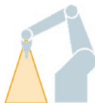
Kinematik innerhalb des kegelförmigen Toleranzbereichs
