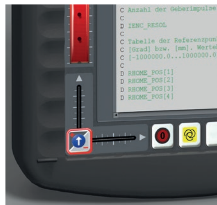
5. Funktionsauswahl durch L-förmige Geste entlang zweier Gehäusekanten
